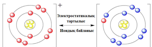
1-сурет. Натрий фториді молекуласындағы иондық байланыстың түзілуі
